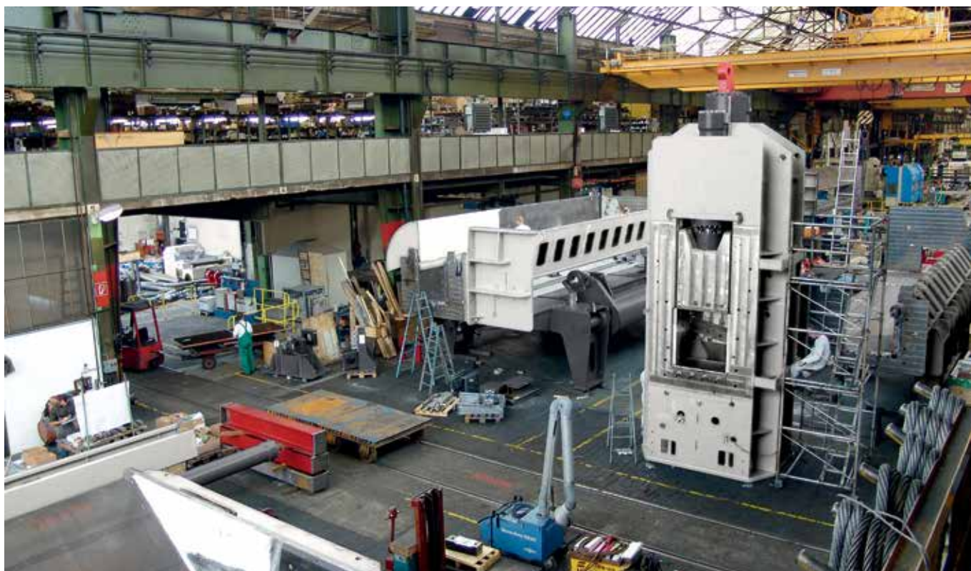
Montagem de uma prensa tesoura na fábrica Metso em Düsseldorf, Alemanha
